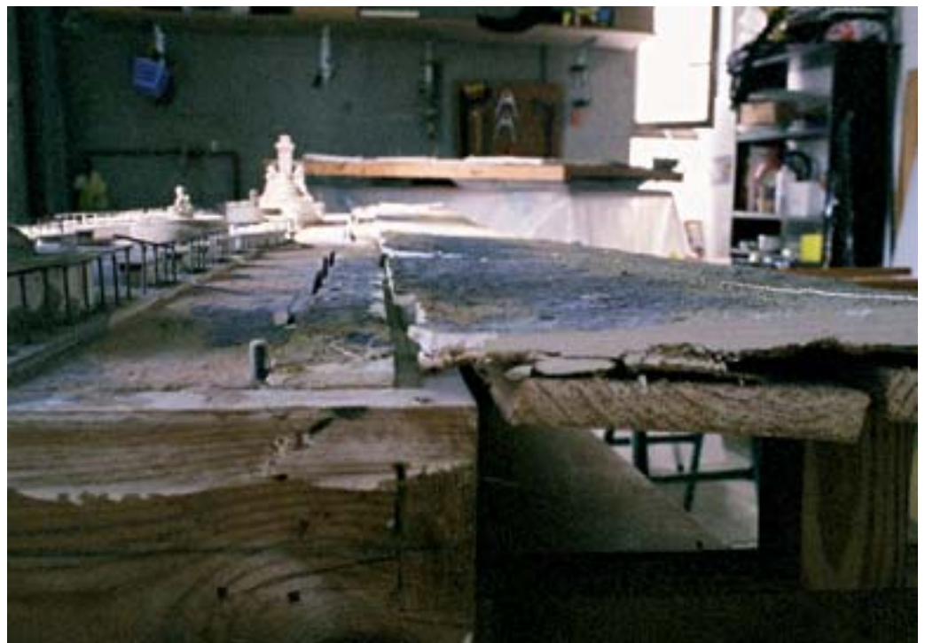
Aspecte del perfil de la part central amb descohesions evidents a la fusta i el guix. 966 MuHBA.
